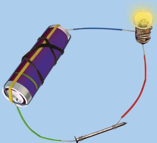
Fig. 4.2 : Electric tester
